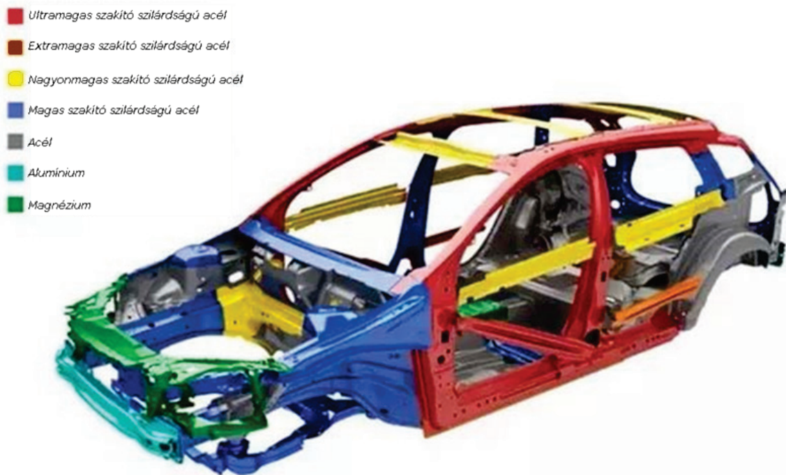
4.7. ábra. Különböző fémek alkalmazása karosszériánál 5
