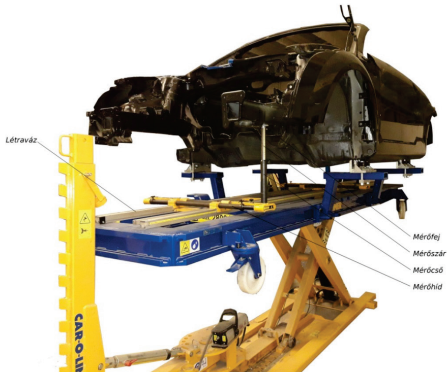
8.13. ábra. Car-O-Liner részei mérés közben
