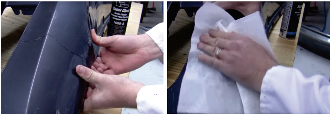
9.1. ábra. Műanyag alkatrész hegesztési folyamata 58
