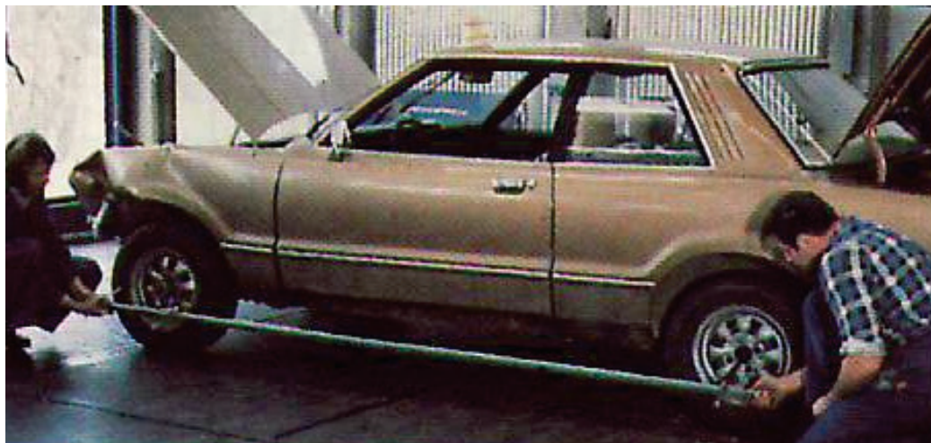
8.7. ábra. Sérült autó tengelytávmerése
