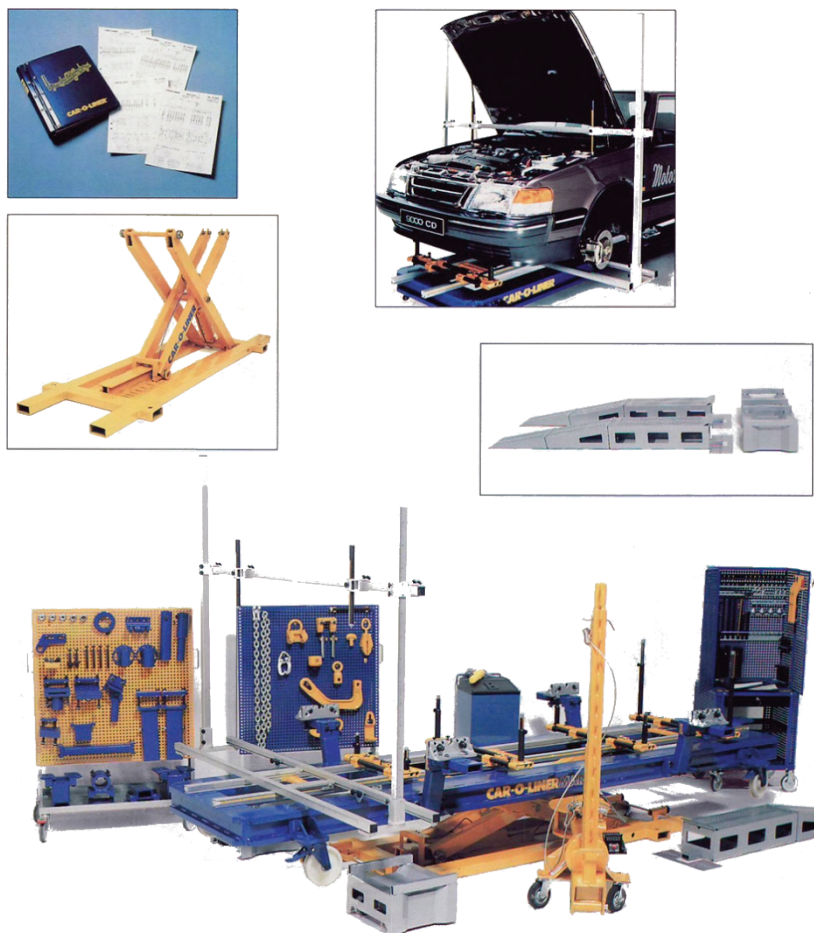
8.12. ábra. Car-O-Liner manuális mérőrendszer 51
