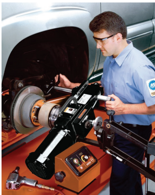
10.5. ábra. Járművön történő féktárcsa esztergálás 67
