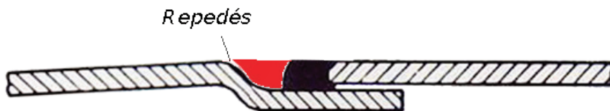
7.30. ábra. Lemez terhelése során elváló kitt
