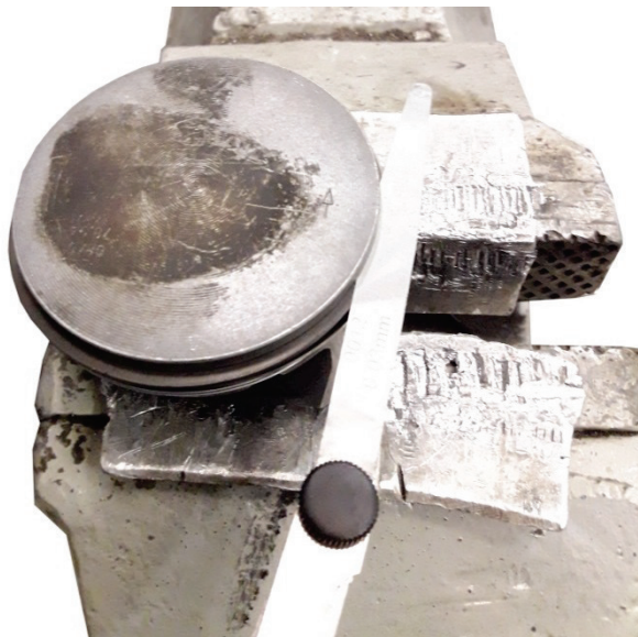
10.9. ábra. Dugattyúgyűrű hézag mérése
