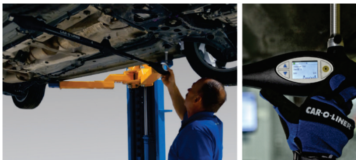
8.2. ábra. Car-O-liner PointX mérőeszköze 49
