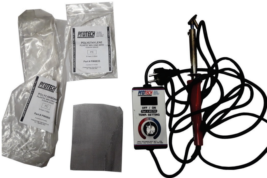
9.8. ábra. Műanyagforrasztó berendezés és alkalmazott anyagai
