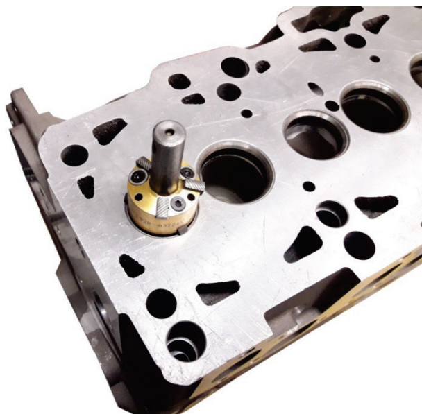
10.15. ábra. Lapkás megmunkálószerszám ráhúzva a vezető tűskére
