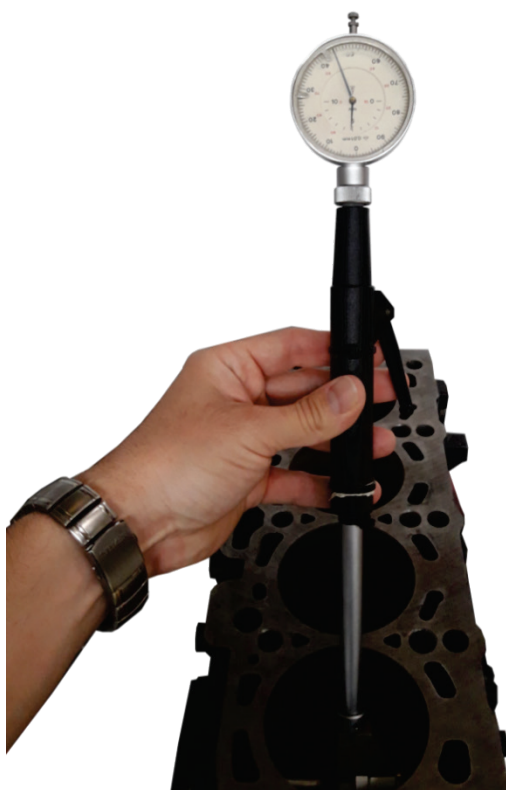
2.10. ábra. Furatátmérő meghatározása mérőóra segítségével
