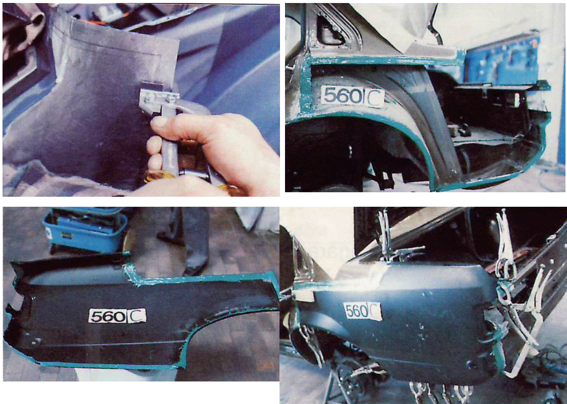
7.32. ábra. Ragasztás alkalmazása karosszéria javítás esetén
