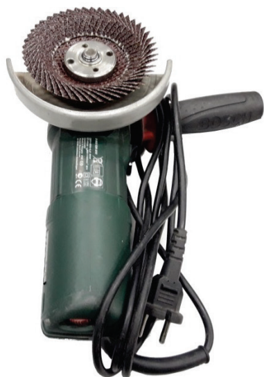
9.5. ábra. Állítható fordulatszámú csiszológép, durva lamellás koronggal
