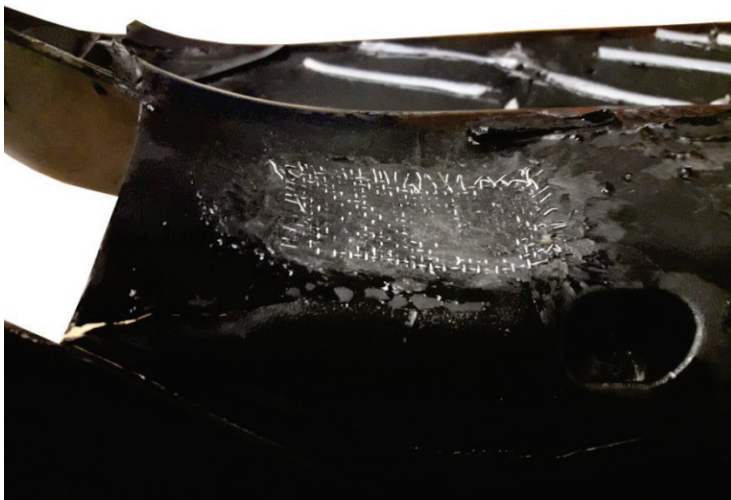
9.10. ábra. Háló beleolvasztása a felületbe
